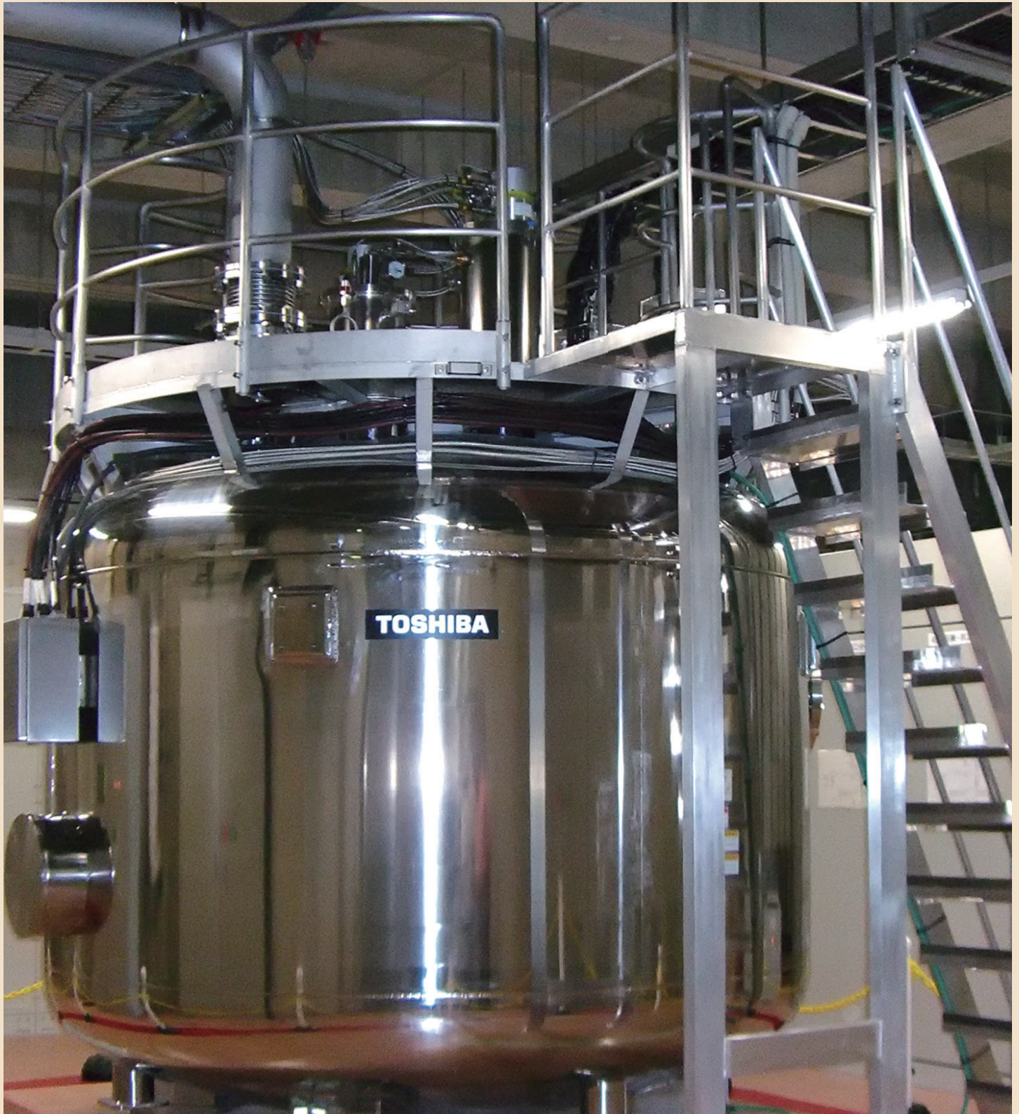
●(独)産業技術総合研究所(つくば西)設置SMES / 提供(独)産業技術総合研究所
